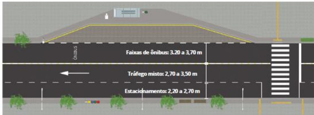
Figura 1 - Largura das faixas de ônibus, faixa de rolamento/trafego misto, e faixa de estacionamento
